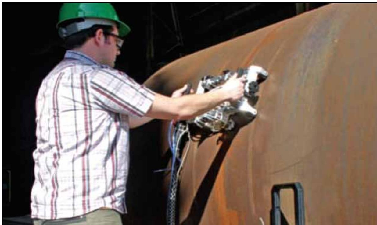
Figura N° 13. Ejemplo de escáner mecánico para inspección de soldaduras.
