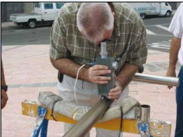
*Fotografía N° 19. Análisis espectrométricos.*
