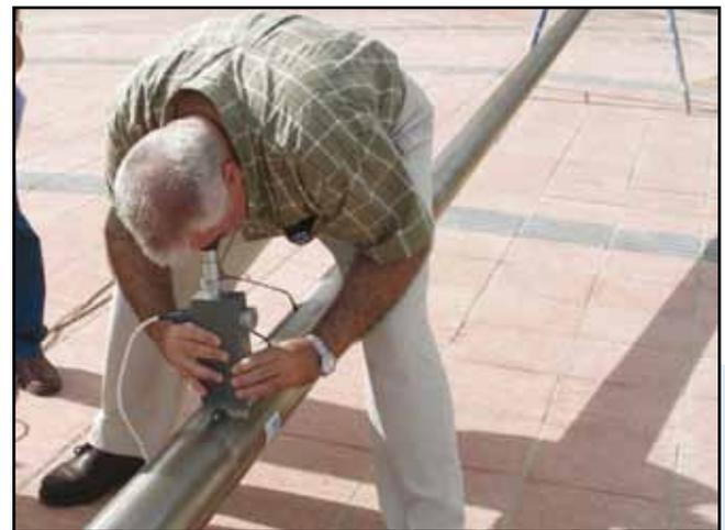
*Fotografía N° 20. Análisis espectrométricos.*
