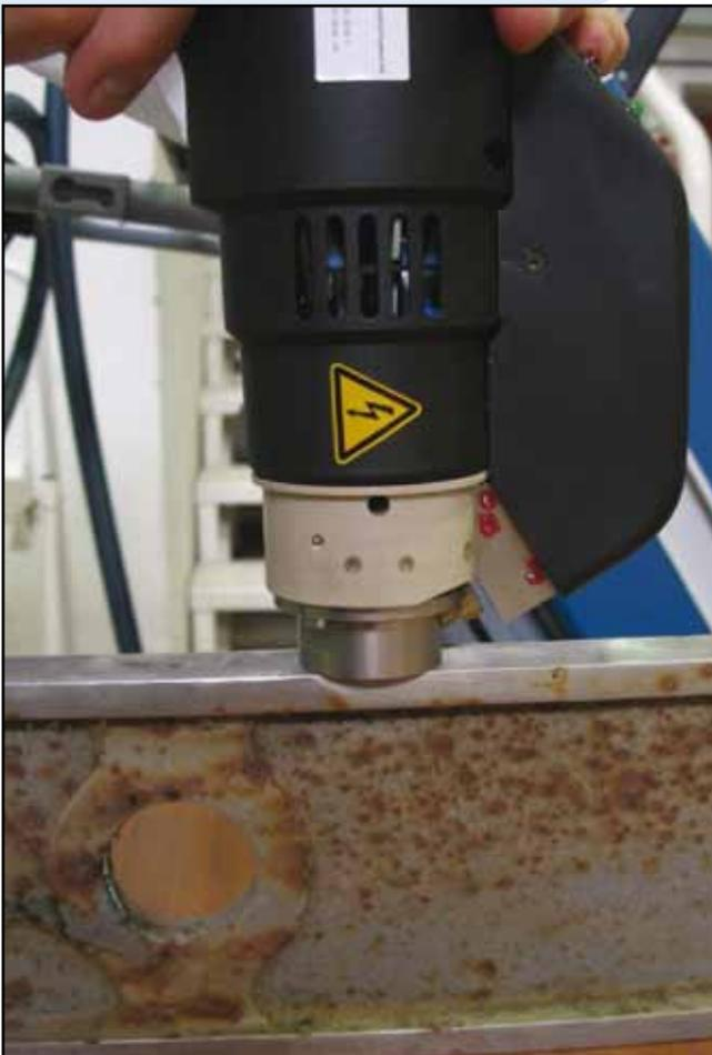
*Fotografía N° 10. Análisis espectrométrico.*
