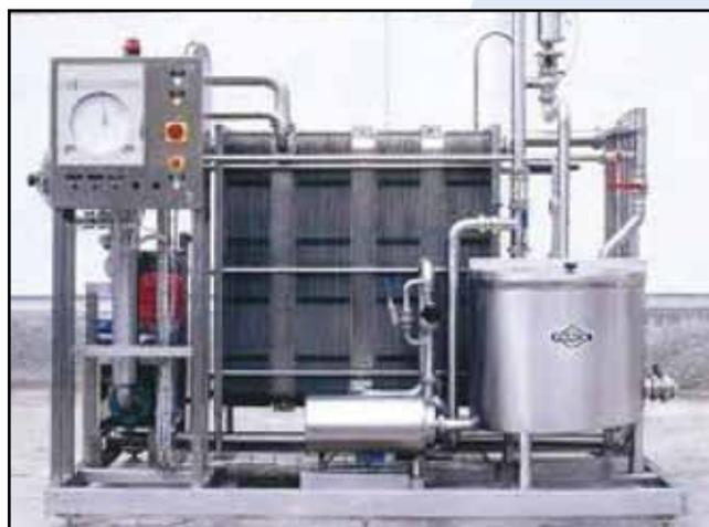
Fotografía N° 5. Intercambiador de calor (AISI 316)
