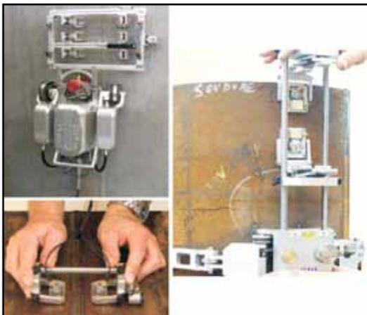
Figura N° 4. Distintos modelos de escáneres mecánicos según la soldadura a inspeccionar.
