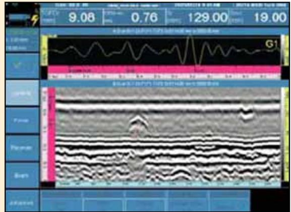
Figura N° 5. Pantalla OmniScan MX con un registro de un canal TOFD
