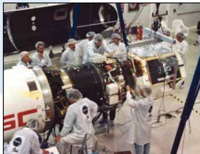
Foto N° 11: Integración del Minisat-01 en las instalaciones del INTA en Madrid.
