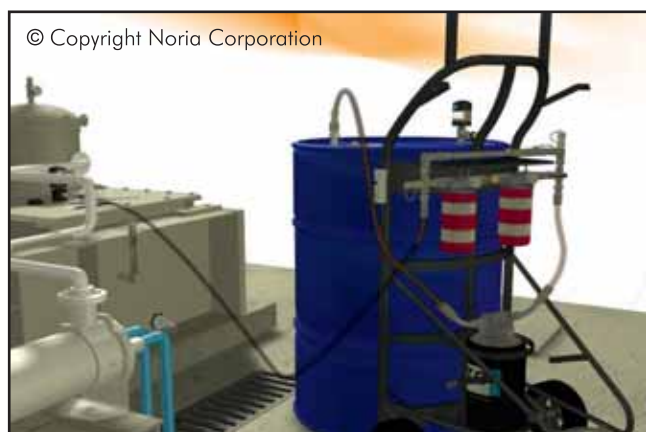
Figura N° 6: Filtrar los lubricantes antes de introducirlos a la maquinaria asegura su adecuado desempeño.
