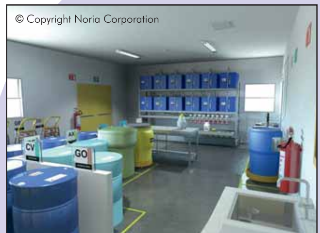
Figura N° 5: Orden y Limpieza en el Cuarto de Lubricación.
