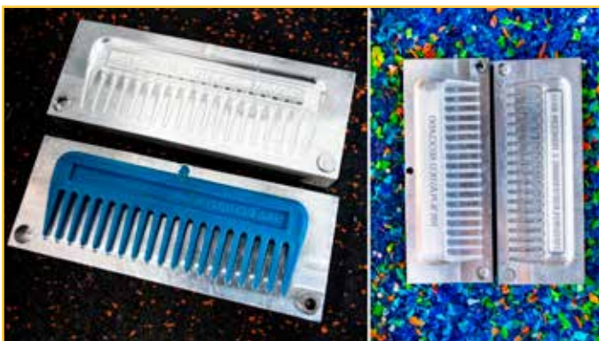
Foto Nº 11: Moldes de los peines elaborados con plástico 100% reciclado en Eysen Hidráulica. Foto de Juan Antonio Rico, fotógrafo colaborador del proyecto ARBol.
