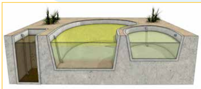
Figura Nº 3: Esquema general de un proceso de Lagunaje. Fuente: ITC.
