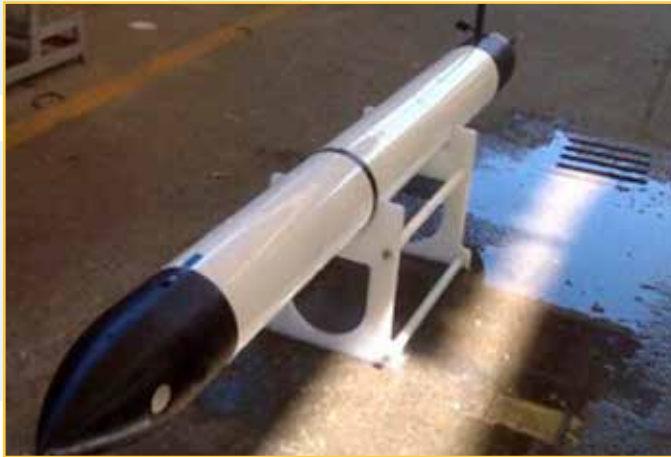
Figura N° 5: GRAALTECH AUV desarrollado por GRAALTECH, "La Folaga". (19)
