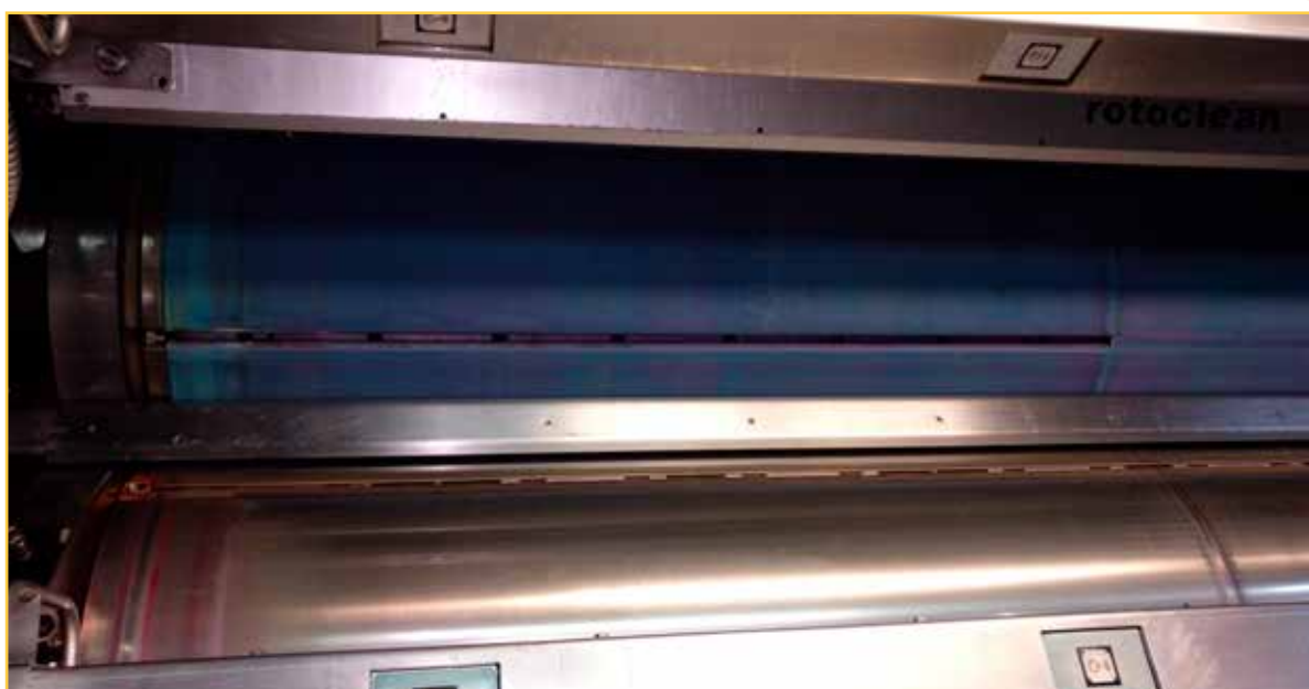
Foto N° 4: Mantilla instalada en un cilindro de una rotativa.
