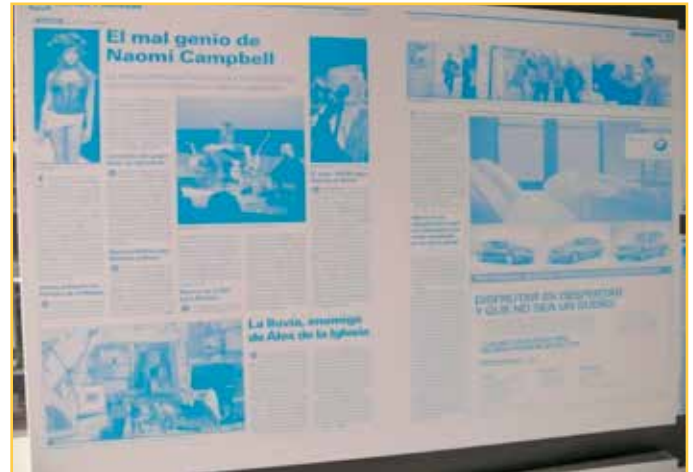
Figura N° 7: Plancha de Impresión (aluminio).
