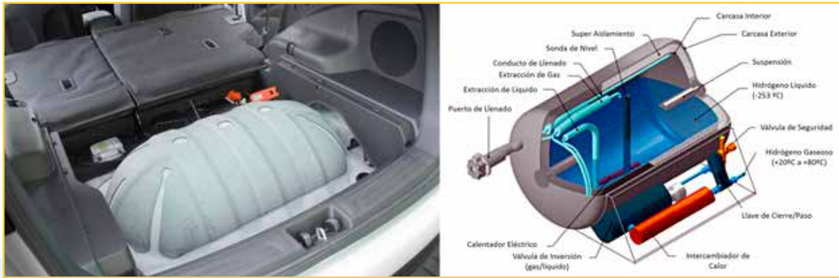
Figura N° 8: (Izquierda) Tanque de almacenamiento de H 2 líquido en el maletero de un BMW híbrido. (Derecha) Diagrama esquemático mostrando la arquitectura del tanque de almacenamiento. (23)
