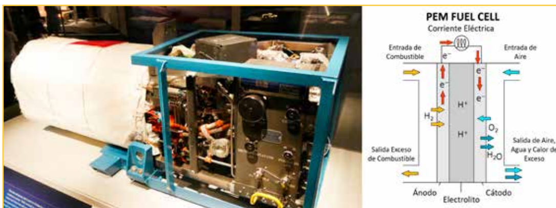
Figura Nº 7: (Izquierda) Pila alcalina usada en misiones espaciales debida a su alta eficiencia. (Derecha) Principio operacional de una pila de hidrógeno (22) .
