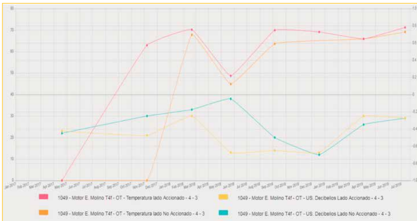
Figura Nº 2: Datos de ultrasonidos y temperatura de un motor en los dos últimos años.
