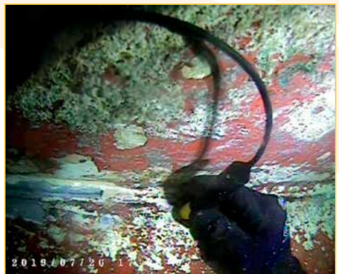
Fotos N° 11 y N° 12: Inspección de los cordones de soldadura de la moon pool de una plataforma petrolífera con Eddy Current para verificar ausencia de grietas.
