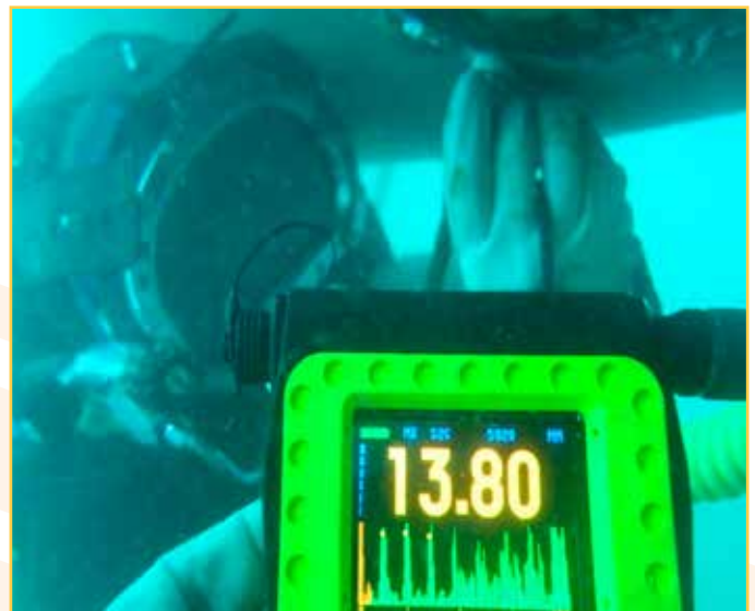
Fotos N° 9 y N° 10: Toma de espesores en el casco de un barco pesquero, previos a una reparación submarina, después de haber localizado una vía de agua.
