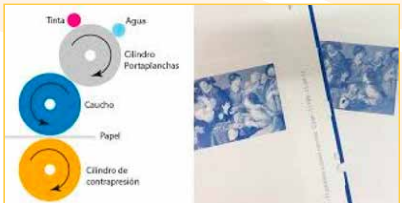
Figura Nº 4: Elementos del cuerpo de impresión offset en máquinas rotativas.
