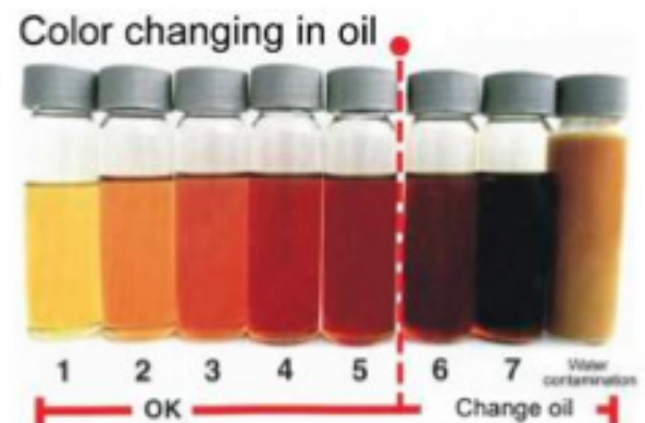
Figura 1.- Comportamiento del cambio de color del aceite en función del estado de degradación
