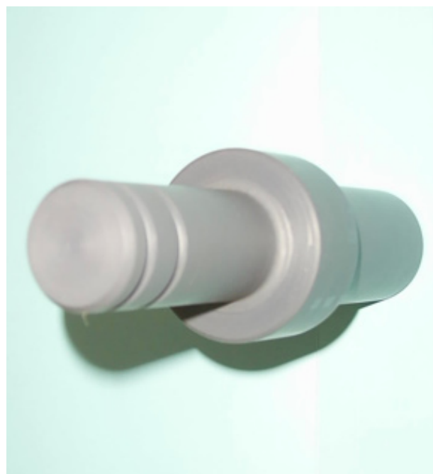
Foto: CONECTORES CIEGOS FABRICADOS EN TALLERES LOCALES EN PVC
