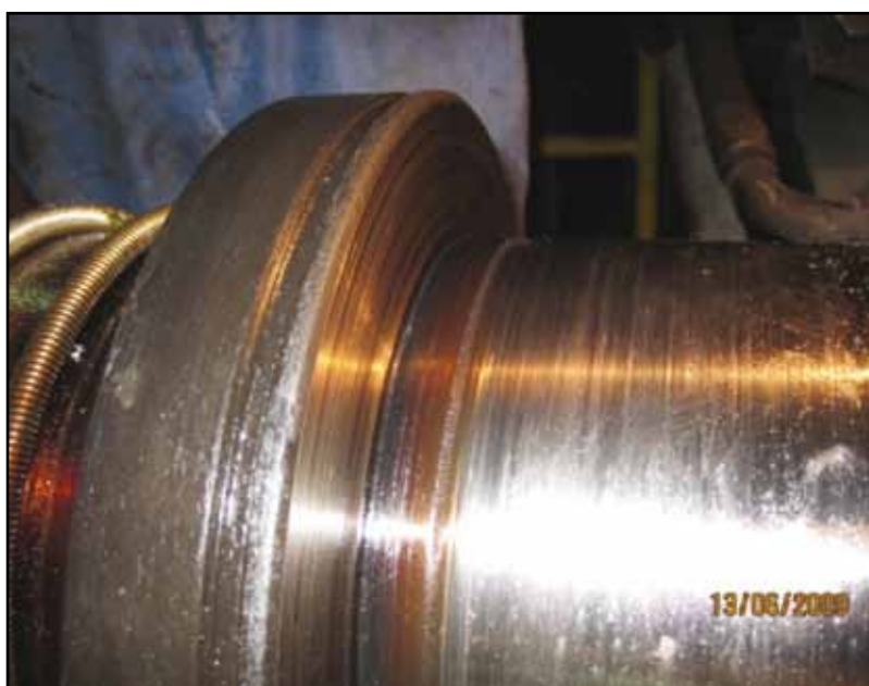
Figura nº 7. Detalle de la muñequilla del eje del ventilador. Se observa desgaste por deslizamiento severo.
