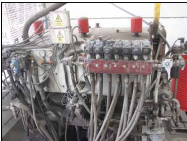
Foto 3: Sistema hidráulico de prensa de adoquines.
