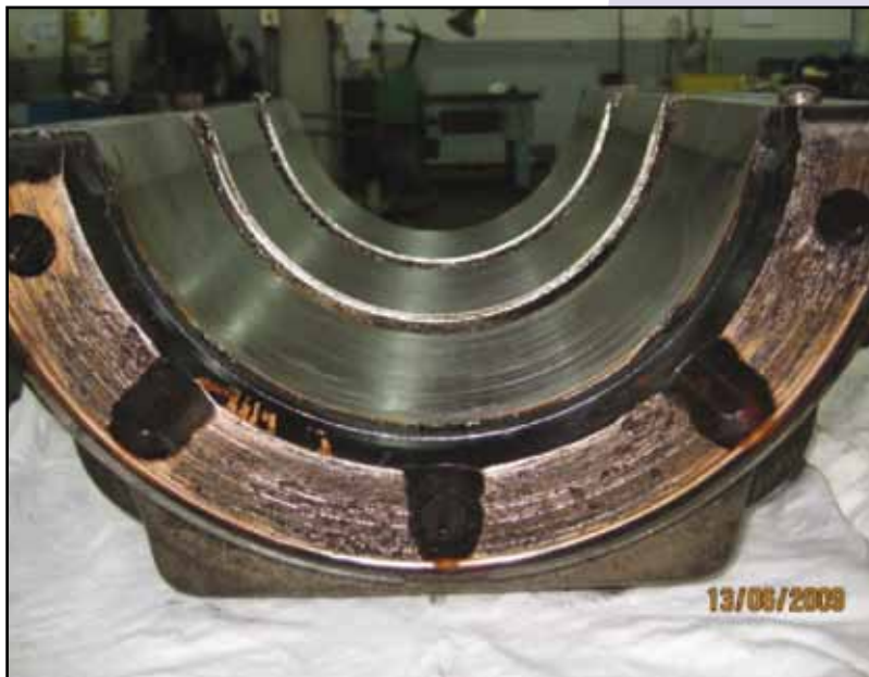
Figura nº 6. Detalle del collarín de empuje del cojinete del ventilador. Se observa desgaste por deslizamiento severo.
