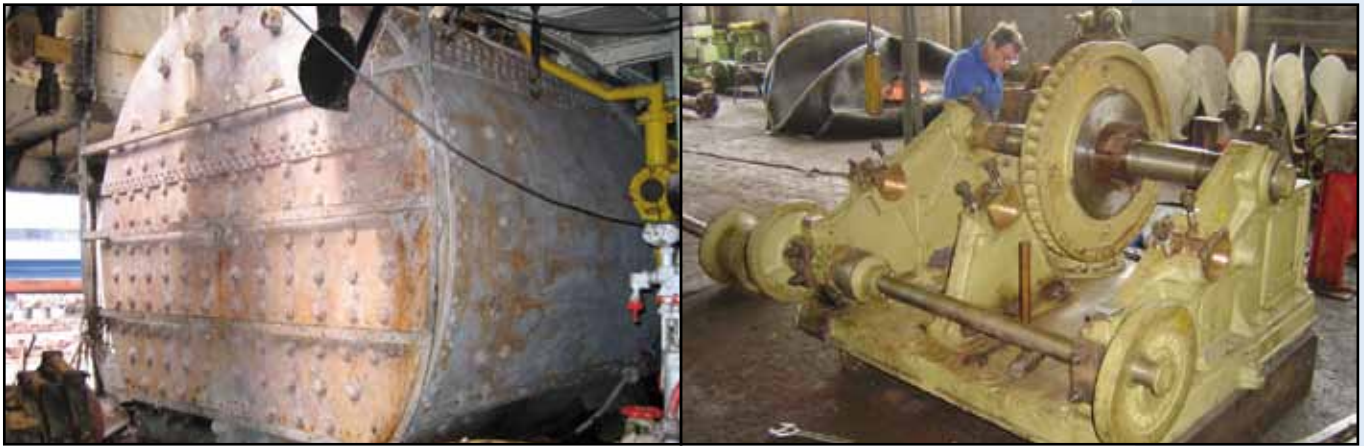
Figura N° 11: Caldera de vapor y molinete. Archivos de Don José Luis Serrano, Fundación Canaria Correílo La Palma y del Autor.
