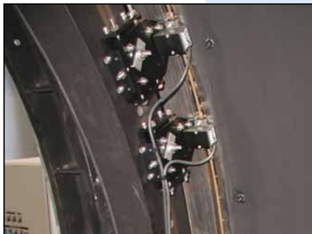
*Figura N° 12: Detalle de una de las cintas codificadoras del eje de elevación y dos de los sensores ópticos.*
