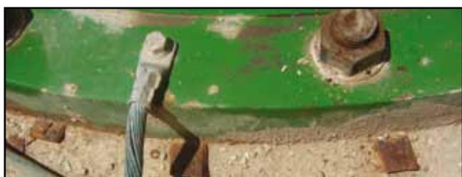
Fotografía N° 3: Detalle placas niveladoras con la bomba montada.
