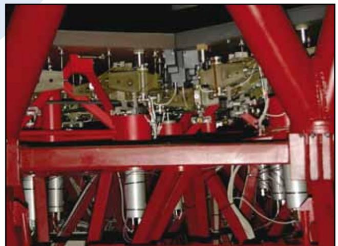
*Figura N° 4: Sistema de actuadores y sensores del espejo primario.*
