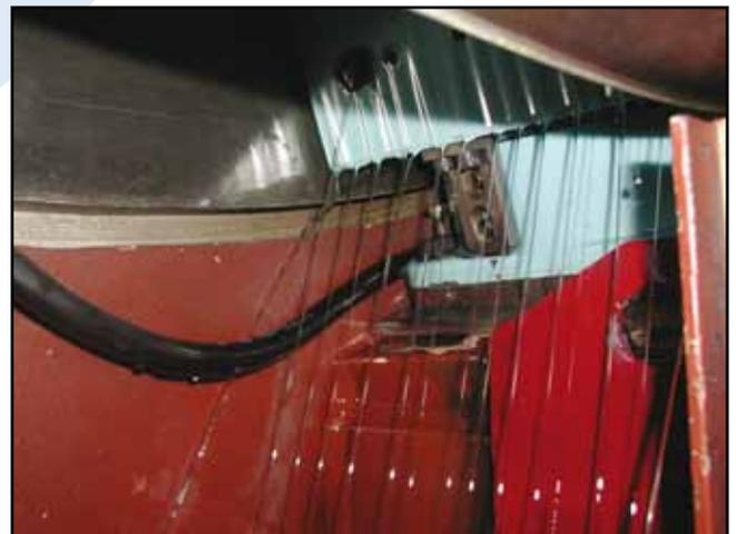
*Figura N° 10: Detalle de una de las zapatas hidrostáticas del eje de elevación en operación.*
