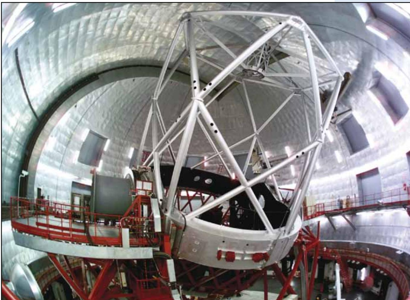
*Figura N° 9: Vista del tubo del telescopio con una de las plataformas Nasmyth de instrumentación a la izquierda.*
