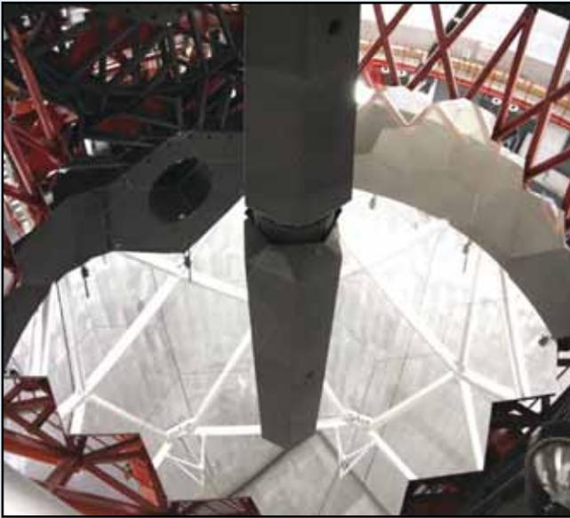
*Figura N° 3: Espejo primario compuesto por 36 segmentos hexagonales con la torre del espejo terciario en su centro. El área colectora total es de 84,2 m.<sup>2</sup> El diámetro máximo del espejo entre vértices de los segmentos es de 11,3 m, el diámetro del círculo equivalente es de 10,4 m.*
