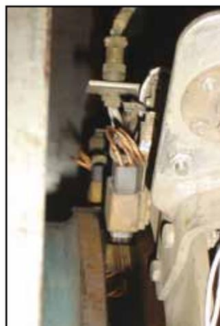
Debido a las altas vibraciones del soporte de escobillas, y a un incremento considerable de temperatura, se decide volver a montar el juego original de acuerdo a las recomendaciones del fabricante.
