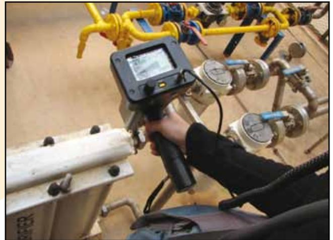
*Fotografía N° 4: Localización Fuga CO<sub>2</sub> con Ultrasonidos.*
