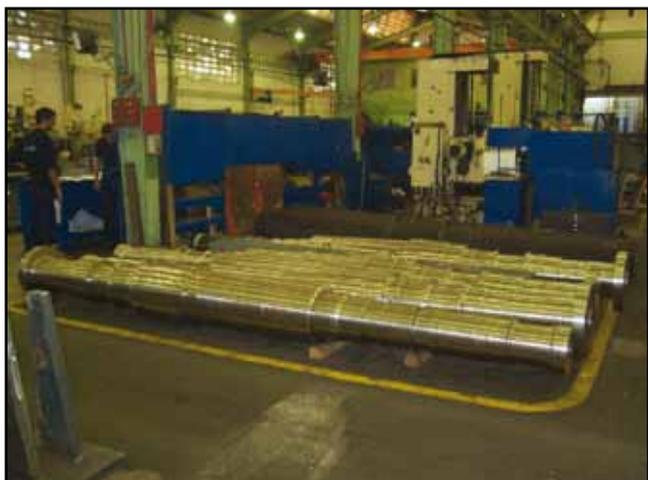
Fotografía N° 14: Ejes turbina.
