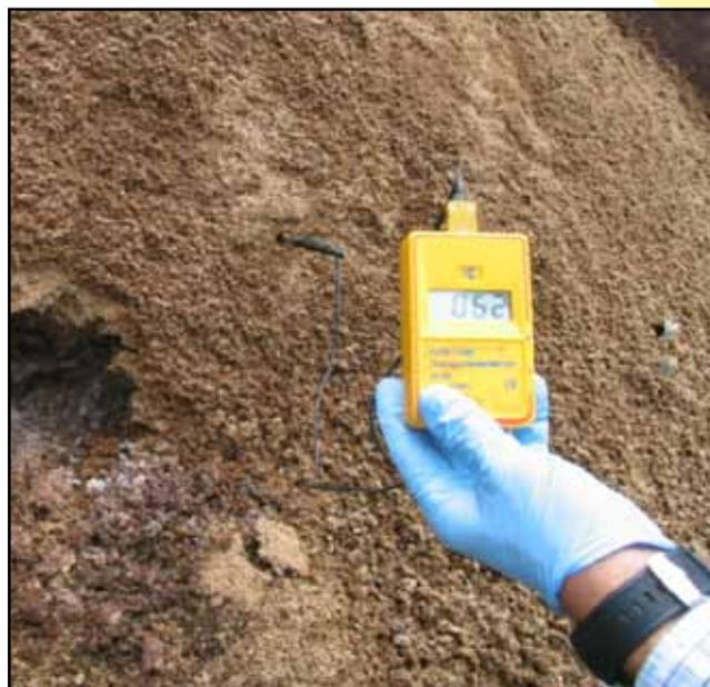
*Foto N° 4: Pila de sólido. Obsérvese la temperatura que marca la sonda (a 1 m de profundidad) de 62°C, perfecta para un posterior compostaje.*
