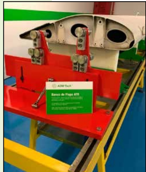
Foto N° 6: Banco de flaps de ATR.
