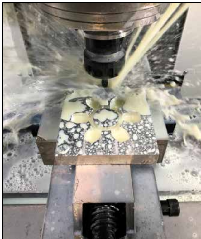
Foto N° 7: Proceso de mecanizado en fresadora.
