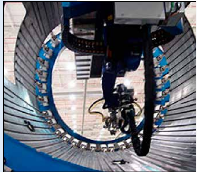
Foto N° 2: Inspección automática por ultrasonidos de fuselaje de aeronave en material compuesto (MTORRES).
