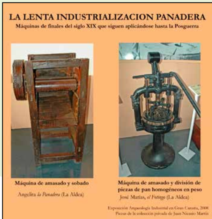
Foto N° 6: Máquinas para mecanizar el amasado del pan.
