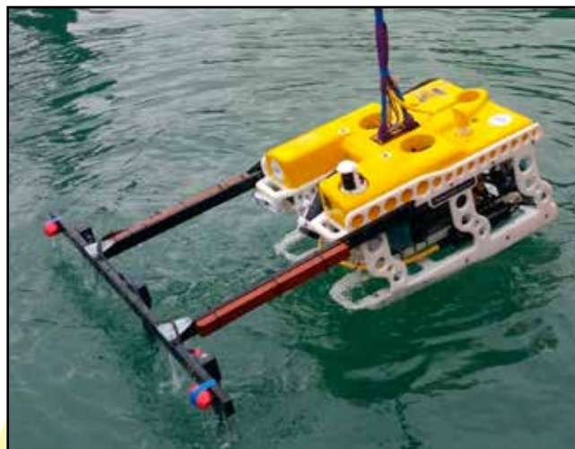
Foto N° 11: ROV con sensores de cable tracking.
